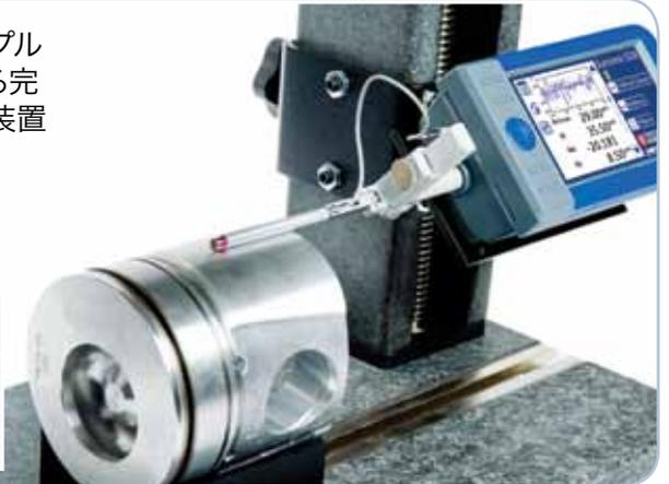
**イントラタッチ**は、粗さ、うねり、輪郭を測定します。現場での高度な表面粗さ解析用の低コストかつポータブルなモデルです。
